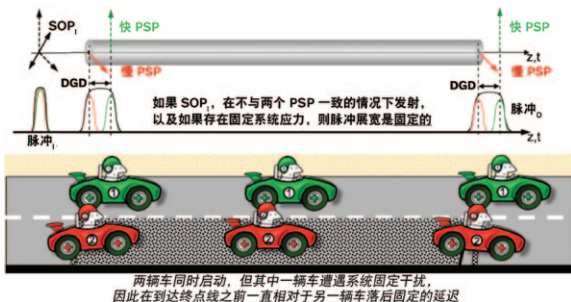
图 17 - SOP 与两个 PSP 均一致的脉冲遭遇固定 DGD 和脉冲展宽
