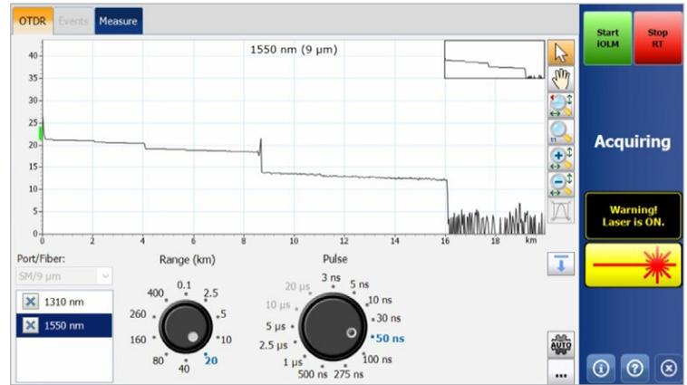
A roda de discagem permitem ajustar os parâmetros de aquisição em tempo real, vendo imediatamente o efeito no rastreamento para a eficiência ideal. Pronto para lançar a caracterização? Basta pressionar o botão "Iniciar iOLM", sem precisar interromper manualmente o tempo real ou entrar em menus.
