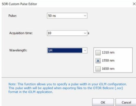
Precisa de uma largura de pulso específica para o SOR no seu pacote de encerramento? Basta pedir que o iOLM adicione-o ao pacote.
