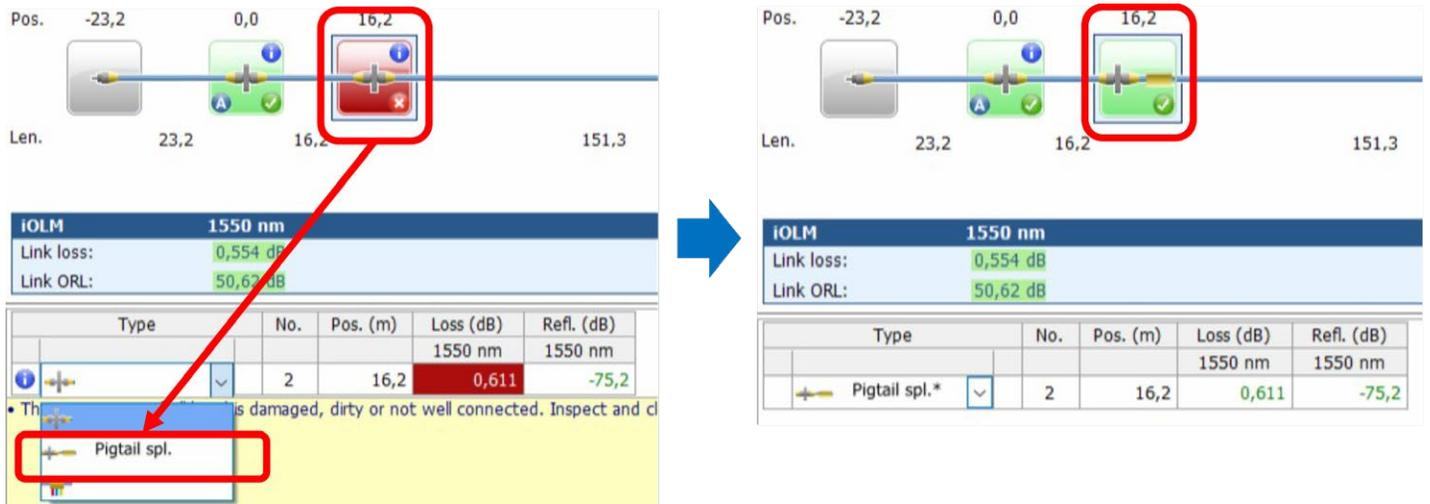
Quando você altera os eventos de um conector comum (limite de 0,5 db no exemplo acima) para um "conector unido pigtail" personalizado, um ícone personalizado é exibido e a unidade se ajusta a um limite personalizado (0,75 db no exemplo acima) para que você possa evitar falsas falhas. Os elementos modificados são marcados com um asterisco (\*) para rastreabilidade.
