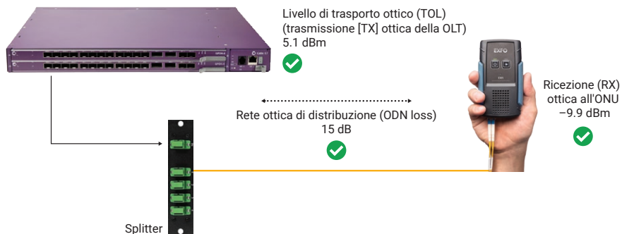
Figura 1. Letture della potenza ottica
