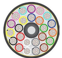
Beispiel für ein Kabel mit 3456 Fasern.
