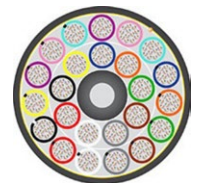
Exemple d'un câble à 3 456 fibres.
