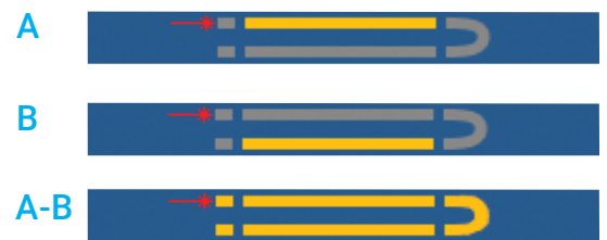
Mit dem Loopback-Modus und der Option iLOOP der iOLM-Anwendung können zwei Glasfasern gleichzeitig gemessen werden. Es ist möglich, nur die A-Faser, nur die B-Faser oder die gesamte Faserstrecke A-B einschließlich Schleife anzuzeigen.
