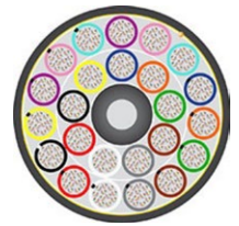
Beispiel für ein Kabel mit 3456 Fasern.
