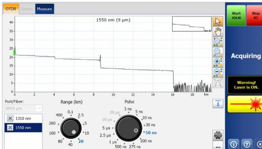
Las ruedas de marcación permiten ajustar los parámetros de adquisición en tiempo real sobre la marcha, además de mostrar al momento el efecto en el rastreo para optimizar la eficiencia. ¿Todo listo para iniciar la caracterización? Solo tiene que pulsar el botón «Start iOLM» (Iniciar iOLM), sin tener que interrumpir manualmente la visualización en tiempo real ni navegar por menús.
