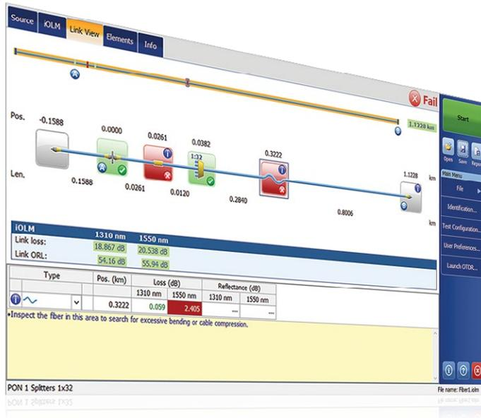
Simplifique las pruebas de OTDR y optimice la precisión de la caracterización para todas las topologías de red. iOLM se basa en algoritmos inteligentes que se adaptan al contexto. iOLM es único en el sector, con capacidad para ubicar e identificar dinámicamente todos los componentes de red y sus errores con la máxima resolución (todo con solo pulsar un botón).
