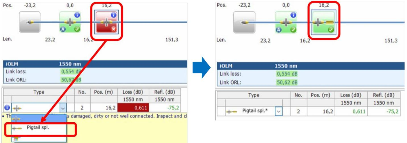
Cuando cambia sucesos de un conector regular (umbral a 0,5 db en el ejemplo anterior) a un «conector con empalme de coleta» personalizado, aparece un icono personalizado y la unidad se ajusta a un umbral personalizado (0,75 db en el ejemplo anterior), para que pueda evitar falsos errores. Los elementos modificados se marcan con un asterisco (\*) para facilitar el rastreo.
