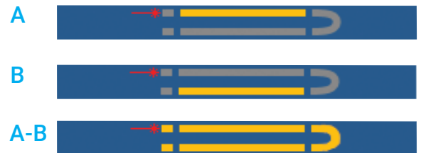
L'utilizzo del metodo di test di loopback e dell'opzione iLOOP sull'iOLM consente di testare due fibre contemporaneamente. Visualizzate solo il collegamento A, il collegamento B o l'intero collegamento A-B, compreso il loop.
