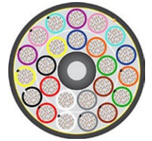
Esempio di cavo a 3456 fibre.
