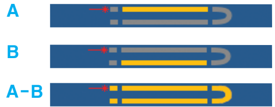
iOLM에서 루프백 테스트 방식과 iLOOP 옵션을 사용하면 파이버 두 개를 한꺼번에 테스트할 수 있습니다. A 링크만, B 링크만 보거나 루프까지 포함해 A-B 링크 전체를 볼 수 있습니다.
