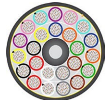
Exemplo de um cabo de fibras 3456.
