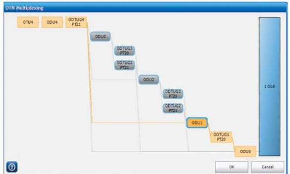
图56. GE-ODU0-ODU1-ODU4信号结构界面。
