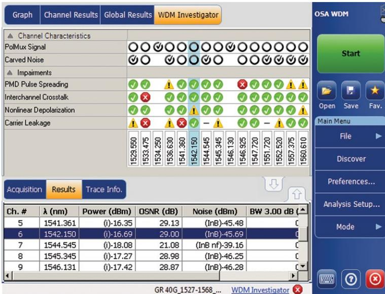
图94. WDM检测器内的非线性解偏振示例。
