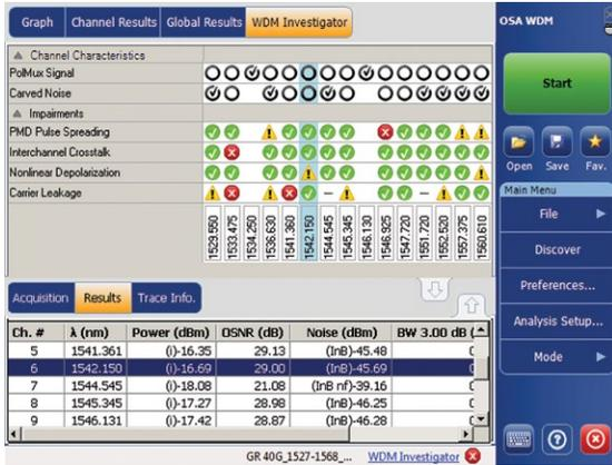
图 111. WDM检测器读数显示非线性解偏振导致更多噪声 (OSNR<sub>e</sub>)。
