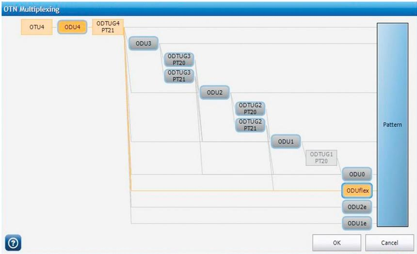
图52. Pattern-ODUflex-ODU4的映射路径。
