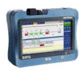
Installation und Fehlerdiagnose an FTTH-Netzen
