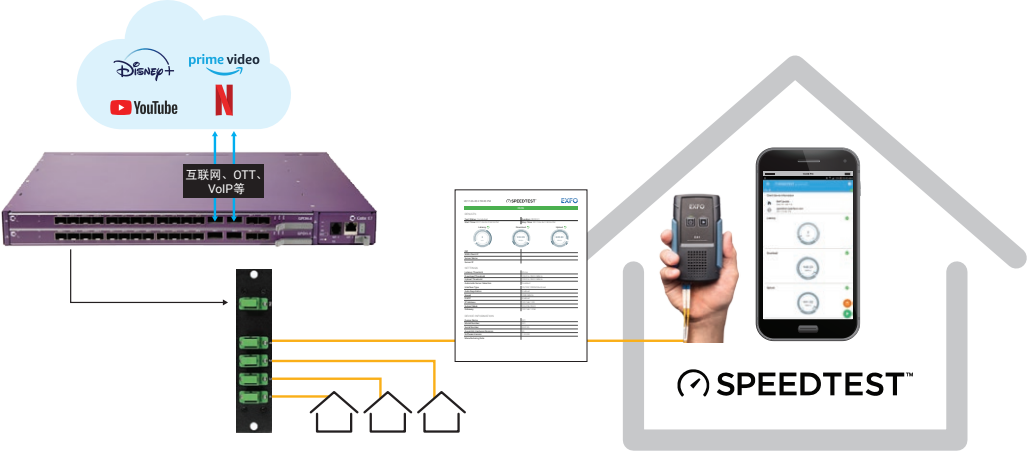
图3: 在GPON或XGS-PON上进行Speedtest测试
